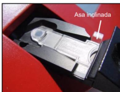
**Figura 03:** Microcuveta posicionada corretamente no equipamento
