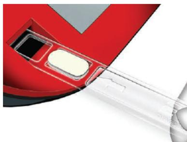
**Figura 15:** Sentido de introdução do instrumento de limpeza
