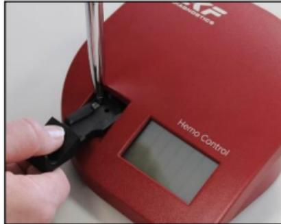
**Figura 14:** Orientação de como remover o suporte da microcuveta
