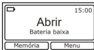
**Figura 02:** Indicativo no painel de nível de bateria e alerta de baixo nível de bateria
